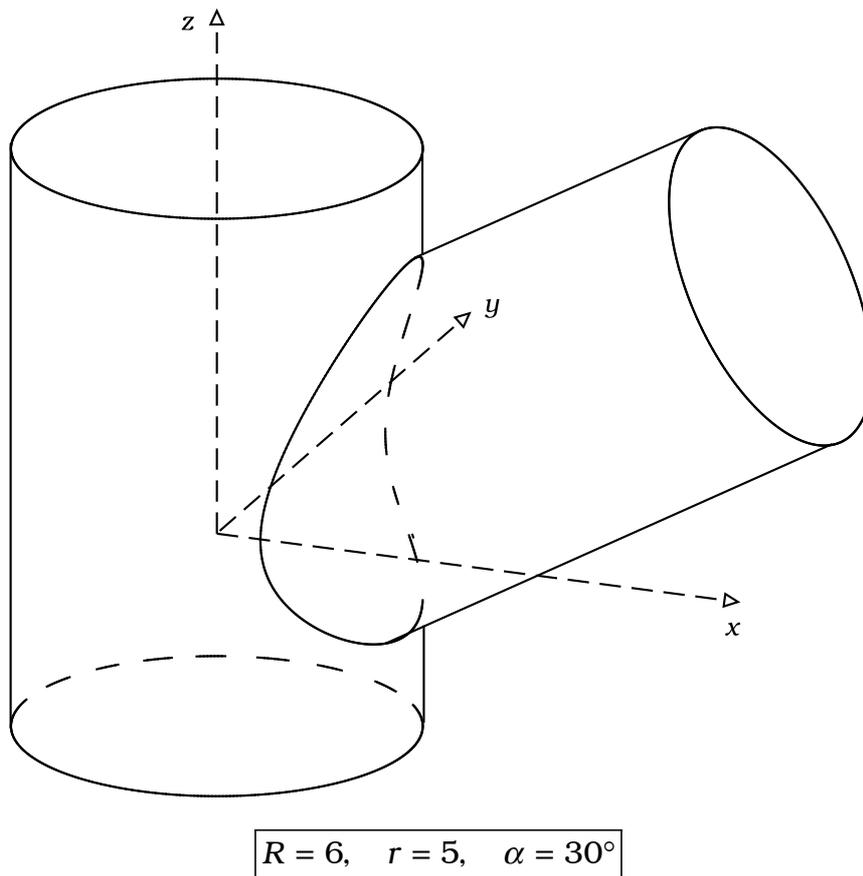
Ist die Achse des Kreiszyinders mit dem kleinen Radius  $r$  in der  $xz$ -Ebene um den Winkel  $\alpha$  gegen die  $x$ -Achse geneigt, so gilt mit den Richtungsvektoren
