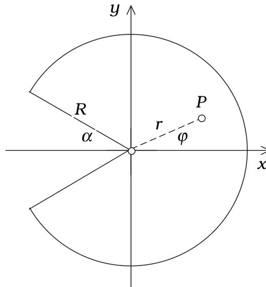
Der Punkt  $P$  mit den Polarkoordinaten  $r$  und  $\varphi$  ist Eckpunkt des infinitesimalen Flächenelementes  $dA$  mit der Kantenlänge  $dr$  in radialer Richtung und der Bogenlänge  $r d\varphi$  auf dem Kreis mit dem Radius  $r$ . Das Flächenelement hat den Flächeninhalt
