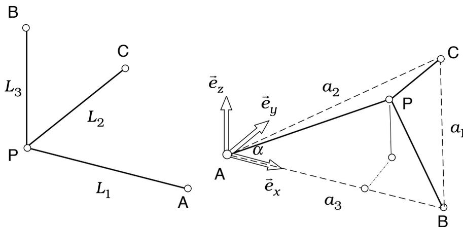
Drei Stäbe mit den Längen  $L_1, L_2$  und  $L_3$  sind im Punkt  $P$  zu einem starren, *orthogonalen* Dreibein verbunden. Dieses Dreibein wird mit den Punkten  $A, B$  und  $C$  auf die  $xy$ -Ebene einer kartesischen Basis gestellt, wobei die Punkte  $A$  und  $B$  auf der  $x$ -Achse des Koordinatensystems liegen sollen. Man berechne die Koordinaten des Punktes  $P$ .
