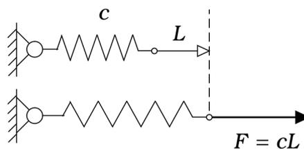
Wird also eine Masse  $m$  im Schwerfeld an eine Feder mit der **Steifigkeit**  $c$  gehängt, so verlängert die Gewichtskraft die Feder um  $L_0$  und die Federkraft  $cL_0$  kompensiert die Gewichtskraft  $mg$ , wobei
