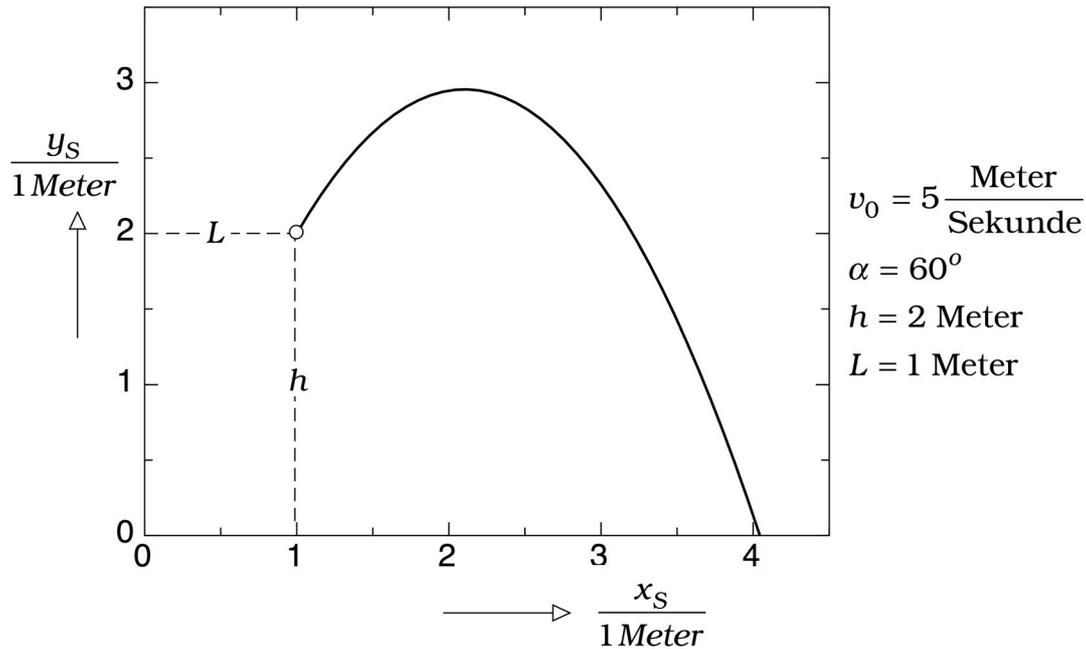
Die Bahn des Scheibenschwerpunktes S ist eine Parabel in der vertikalen  $xy$ -Ebene, die man Wurfparabel nennt.
